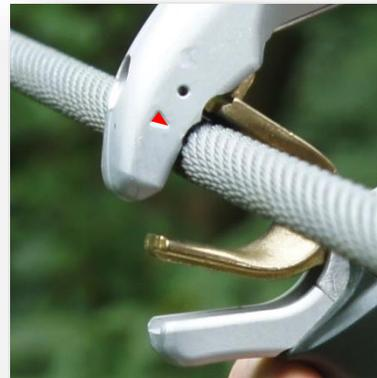
**2** Placez la flèche en face de l'ancrage. Attendez que le barillet soit libéré : Le système de détection d'ancrage "s'auto-verrouille" si l'on force.
